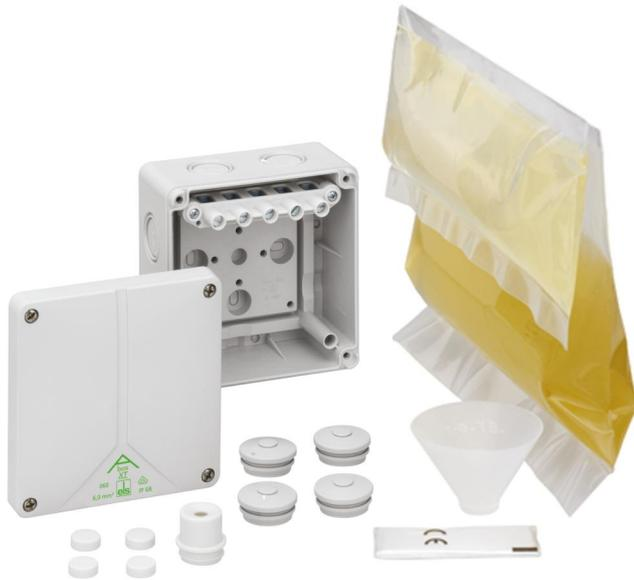
Abzweigkasten, mit Schutzart IP68, Nennquerschnitt 6 mm<sup>2</sup>, Ui=690 V AC, zertifiziert durch VDE (DIN EN 60670-1/-22 (VDE 0606-1/-22) & DIN VDE V 0606-22-100), Ausschlagmembranen, M20/M25, (2 rückseitig, 7 seitlich), innenliegende Befestigungsstellen, mit Schraubklemmen zum Vergießen, zur Montage in Überschwemmungsgebieten und im Erdreich ohne Verkehrslasten
